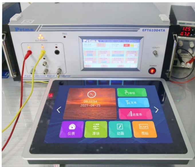
图 4-4 群脉冲测试图
