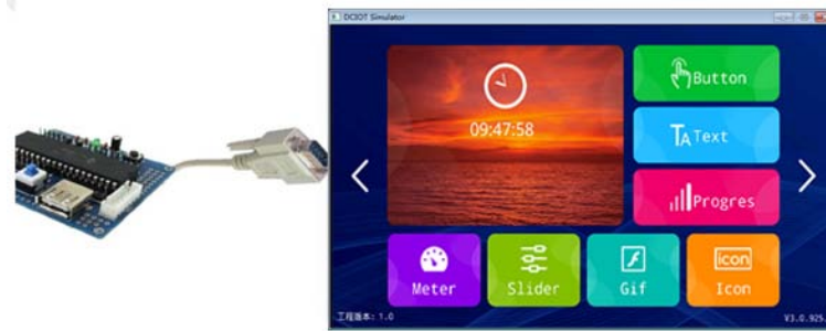
图 12-2 用户单片机串口与“虚拟串口屏”联机调试
