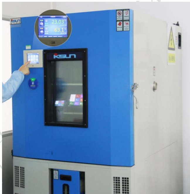
图 4-3 高低温老化测试图
